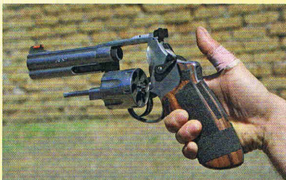
Zulässige Verbesserungen am Revolver: Verlängerter Trommellöser und Skateboard-Tape am Griffstück.
